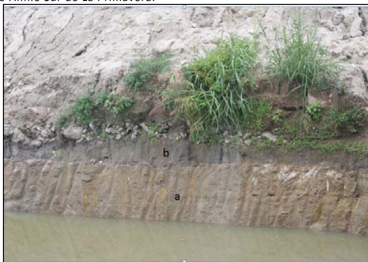
Foto 2-3. Secuencia superficial en la zona Valle del Ahogado. Se identifican los siguientes paquetes: a) Paquete de arenas y limos fluviales; b) Paquete de arcillas café oscuro.
