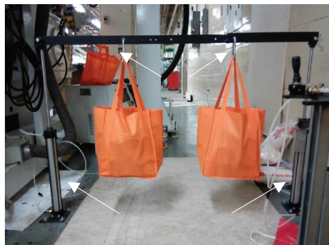
Figura 1. Equipo con pistones paralelos extendidos de forma neumática. Figura adaptada. 3
