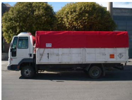
Figura 11. Correcta colocación de lonas en vehículo
