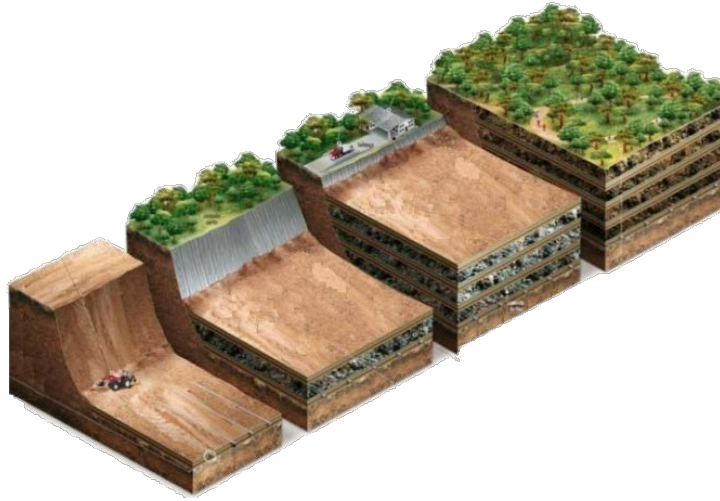
Figura 39. Etapas de clausura de un SDF de RCD.
