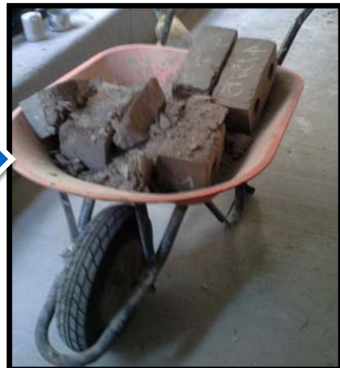
Elementos fallados, después de someterlos a carga
