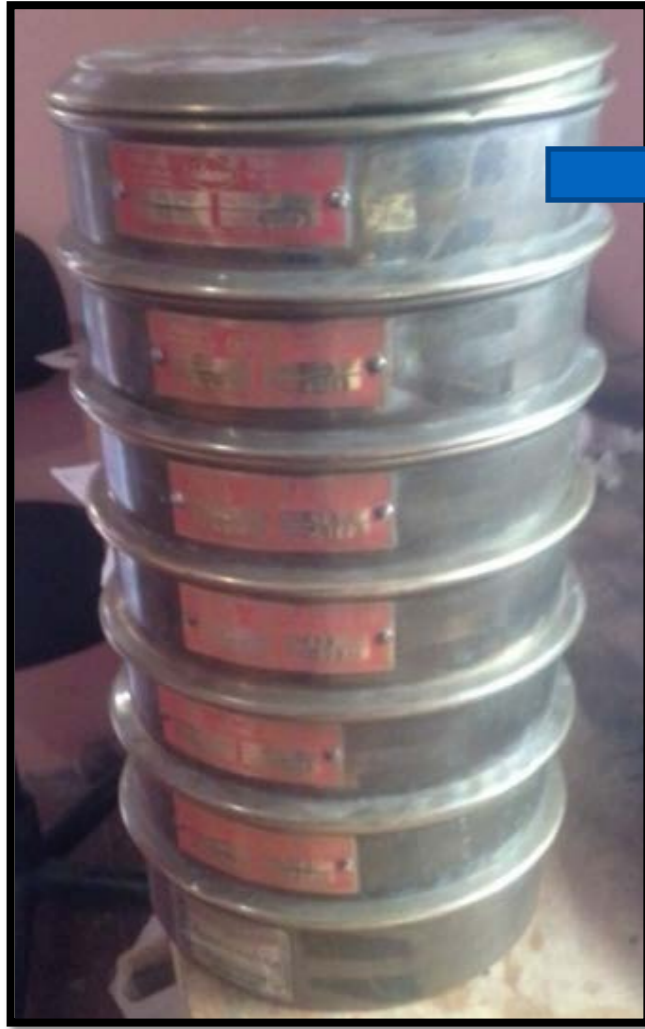
Tamices utilizados para la separación de partículas granulares
