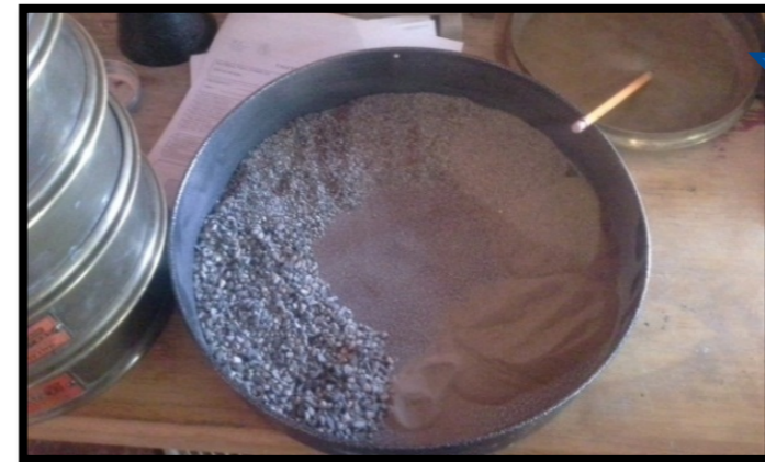
Material separado por tamizado, peso y porcentaje de cada material retenido.
