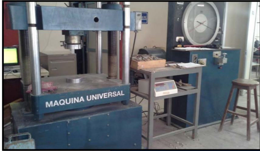
Laboratorio Facultad de Ingeniería UASLP, Prensa Universal marca Controls de una capacidad de 100 ton.
