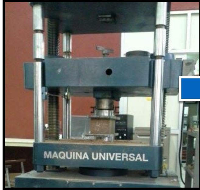
Prensa Universal, con elemento colocado para prueba de compresión.
