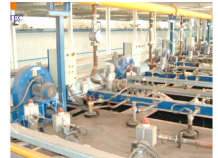
Horno tipo multicámara
