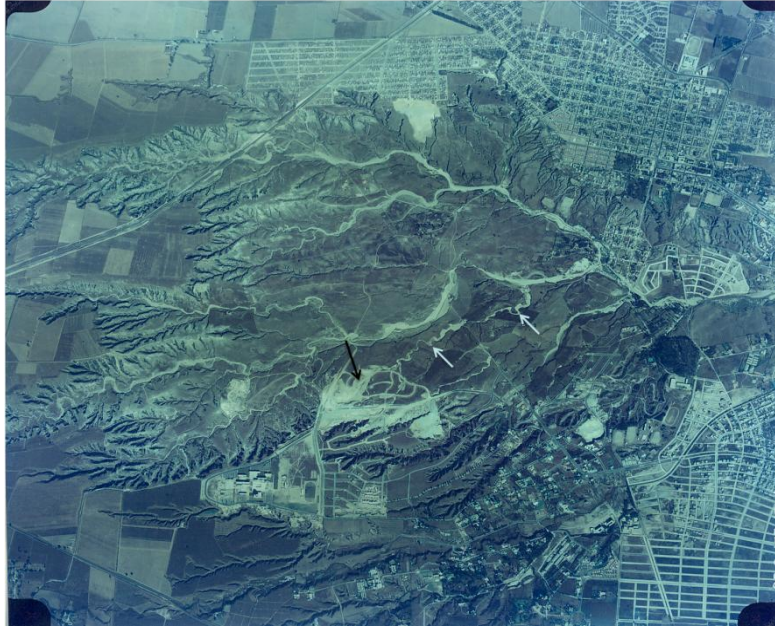
Figura No. 12. Las flechas en blanco indican las zonas de acumulación del material que ha sido removido de las áreas que estaban siendo urbanizadas en la década de los años 1970 (Santa Isabel).
