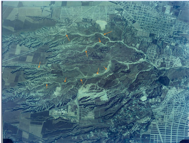
Figura No. 17. Las flechas indican las zonas de acumulación de arenas para el año de 1971, formando lo que se denominó como playones a lo largo de los cauces.
