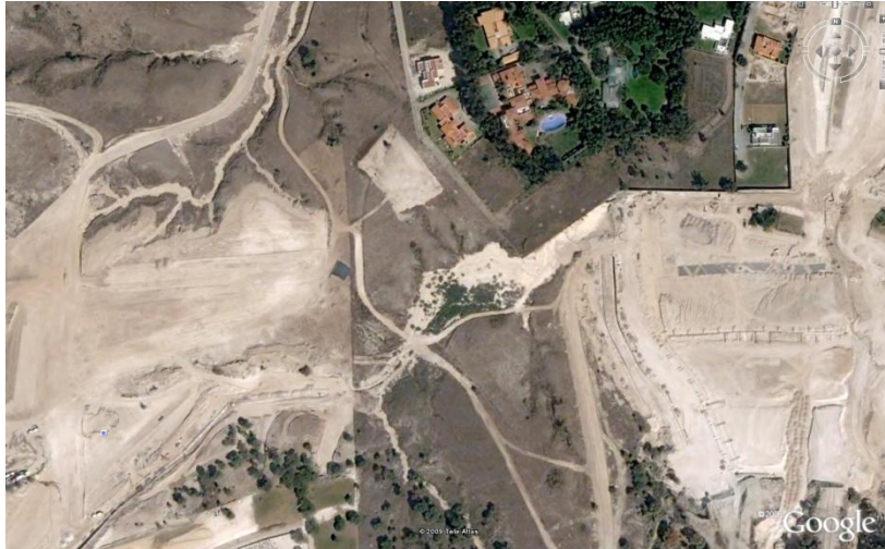
Figura No. 37. El intenso movimiento de tierras ha ocasionado que se dispare la tasa de erosión de los sedimentos. Han llegado a colmatar de manera severa el canal natural, haciendo susceptible que ante una avenida fuerte los sedimentos sean evacuados de manera súbita incrementando el problema de inundación y generando pequeños aluviones (flecha).
